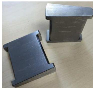
Abbildung 1: Statorsegmente aus SMC
