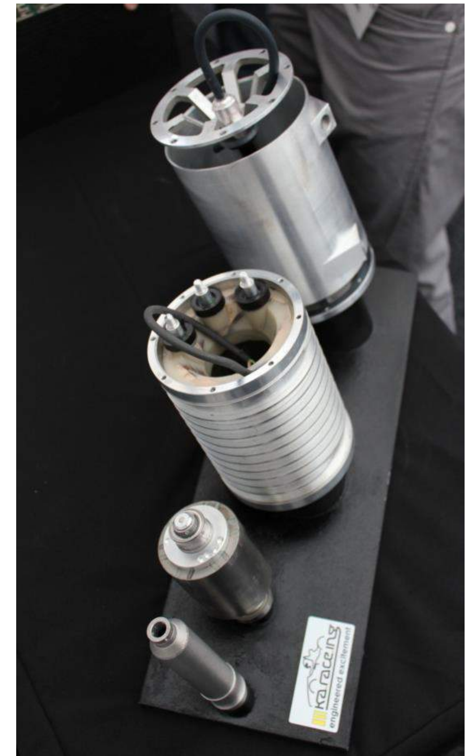
Abbildung 2: E-Motor „ETI S01-30-20“ nach Baugruppen aufgeteilt. Von vorne: Hohle Aluminiumwelle, Rotor mit Permanentmagneten, Stator mit vergossener Wicklung in Alu-Kühlhülse, Gehäuse und Lagerschild mit Drehgeber.
