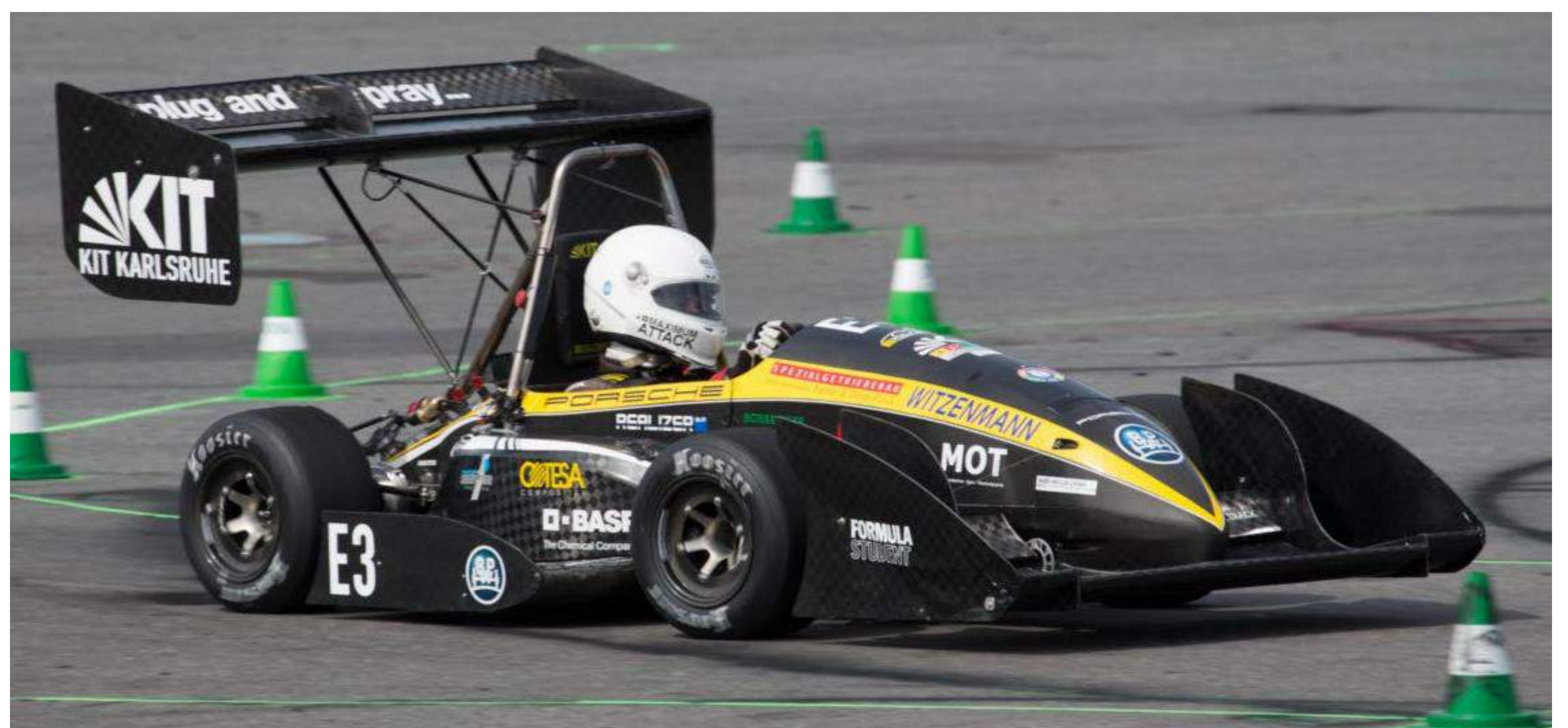
Abbildung 4: E-Motoren im Einsatz. Jedes Rad wird von einem Elektromotor angetrieben.
