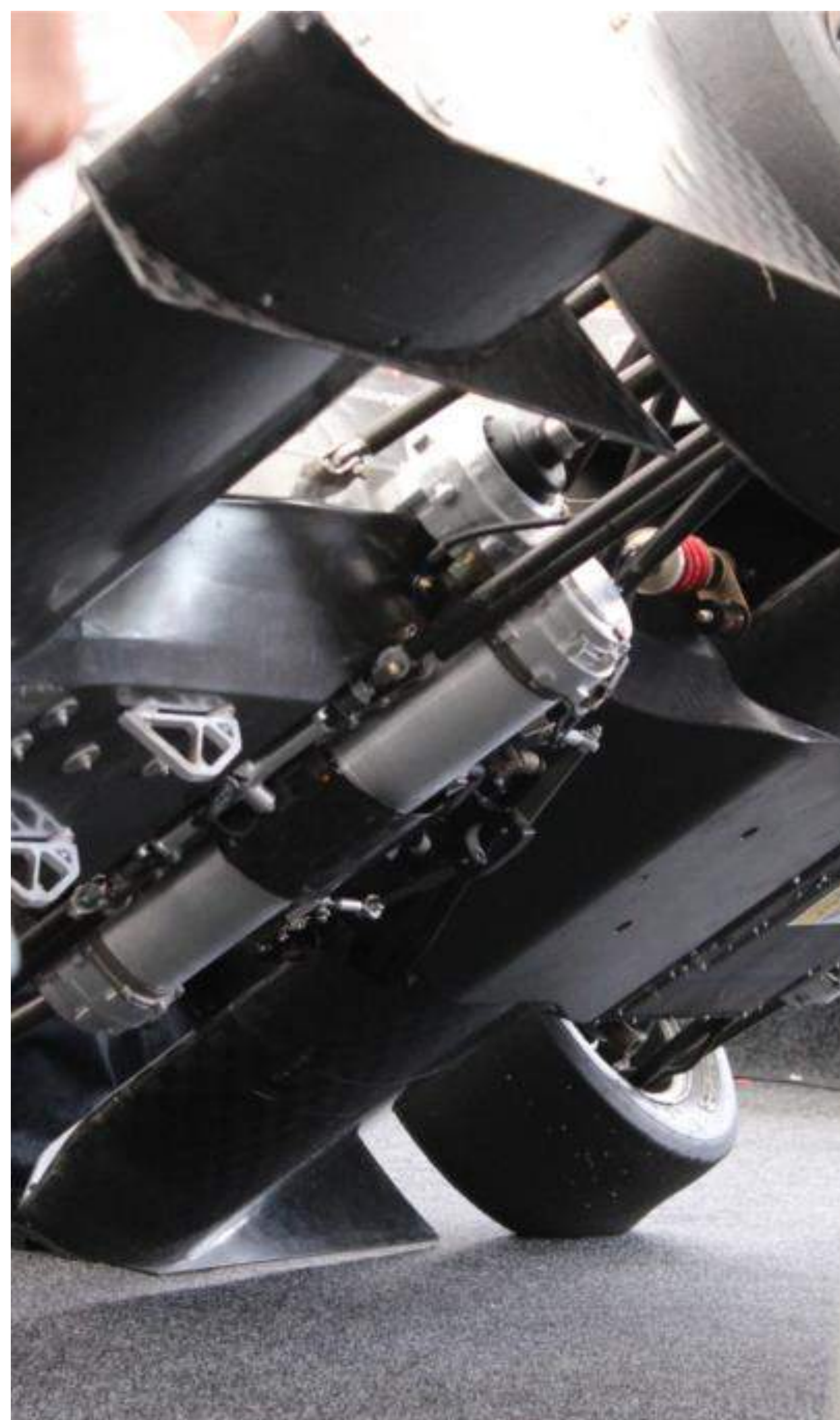
Abbildung 3: Eingebaute E-Motoren an der Vorderachse inklusive Getriebe.
