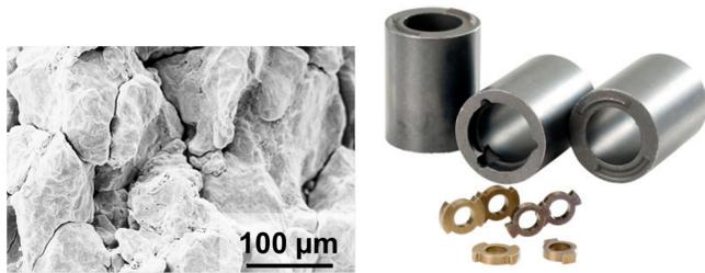
Abbildung 1: SMC-Werkstoff und Bauteile
