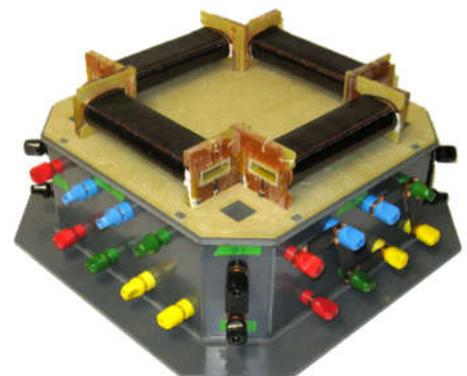
Abb. 1: Epsteinrahmen-Prüfstand mit variabler Spulenkonfiguration
