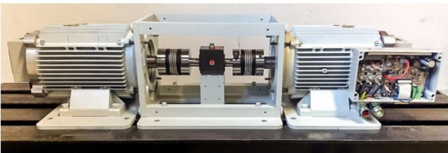
Neben der FEM-Berechnungen soll eine Prototypenmaschine aufgebaut werden. Als Energieübertragung auf den Rotor kommt Schleifring-Bürsten-System oder der rotierende Transformator in Frage. Zur Validierung der theoretischen Untersuchungen wird die aufgebaute Prototypenmaschine am ETI-Prüfstand vermessen.
